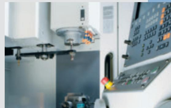
Ein automatisches Werkzeugwechselsystem für **20 oder 30 Werkzeuge** für die werkzeugseitige Automation.
