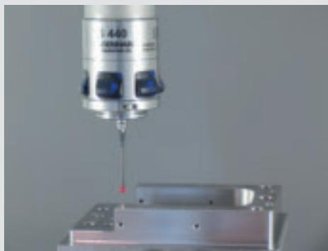
Ein 3D Taster um zeitsparend und präzise Nullpunkte zu ermitteln. Signalübertragung je nach Modell mittels Kabel oder Infrarot.
