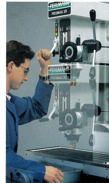
Der Maschinenkopf wird mit einer Handkurbel in der Höhe verstellt. Er ist auf der Säule gegen Verdrehung präzise geführt, so dass die ursprüngliche Position in den X / Y -Achsen mit einer Genauigkeit von  $\pm 0,01$  mm repetiert werden kann.
