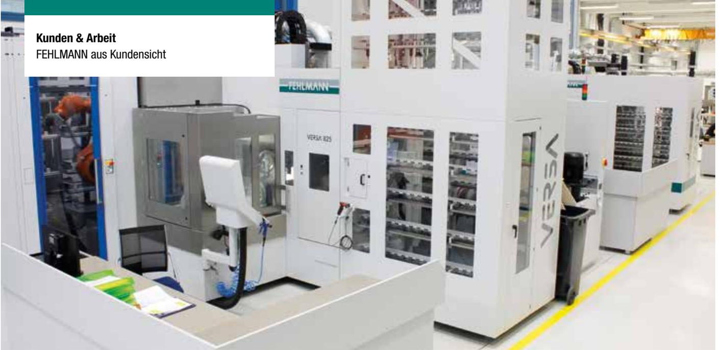
*Kernstücke der Automatisierungslösung bei Test-Fuchs sind die FEHLMANN VERSA 825 und das Werkzeugmagazin mit 346 Werkzeugen.*
