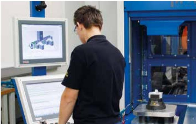
Die Automatisierungszelle mit Schienensystem, Be- und Entladestation, Roboter und Leitrechner wurde von Promot Automation geliefert.
