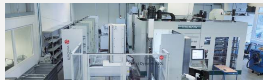
Deux centres d'usinage VERSA à 5 axes avec système de robot modulaire Erowa Robot Dynamic 150L
