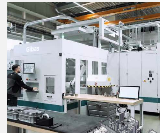
Robot de pièces sur cinq centres d'usinage 5 axes VERSA avec magasin à étagères
