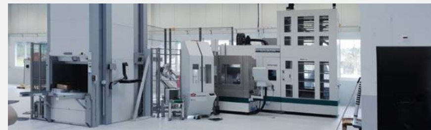
Îlot de production VERSA centre d'usinage 5 axes avec magasin à rack, robot à bras articulé pour la manipulation des pièces brutes et stockage de pièces brutes et finies dans des rayonnages en hauteur.
