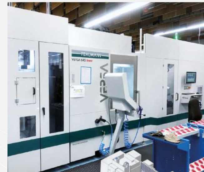
Deux centres d'usinage VERSA 5 axes avec chacun un magasin à étagères sur un système de manipulation de pièces robotisé
