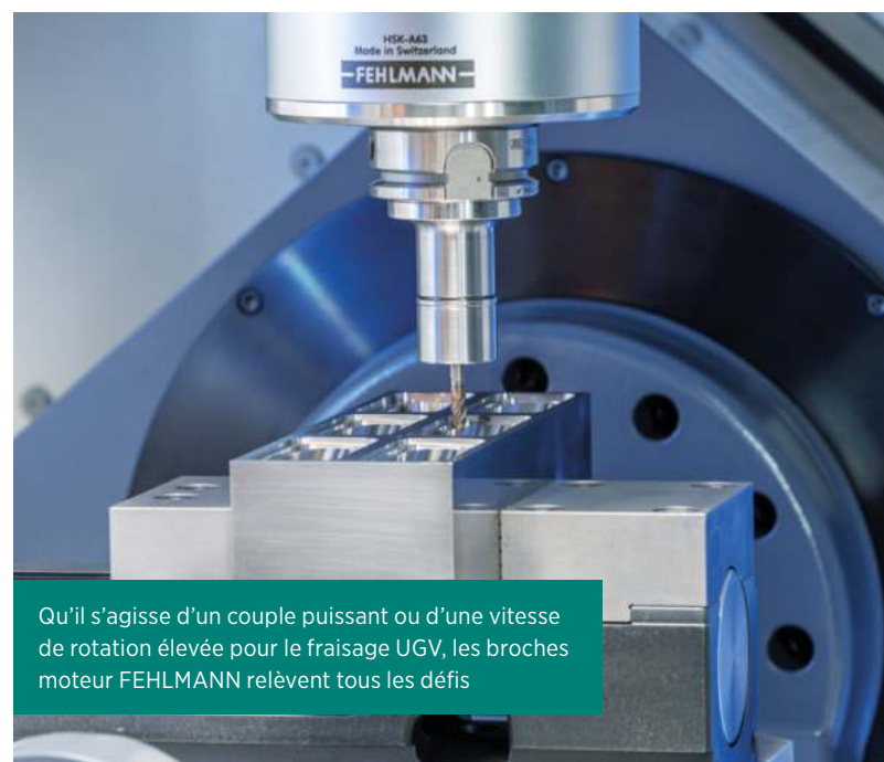
Précision élevée et constante lors du fraisage 5 axes avec le cycle 333 FEHLMANN Auto-Calibration
