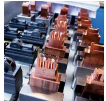
Die beiden Bearbeitungszentren sind zu 30 Prozent mit dem Fräsen von Kupferelektroden ausgelastet. Unabhängig davon werden bei WESKO auf einer anderen Maschine auch Grafitelektroden gefertigt.
