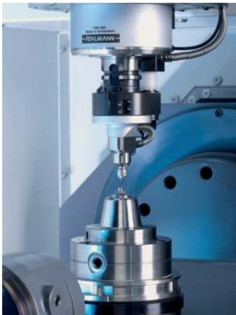
Für Fräs- und Schleifbearbeitungen mit kleinsten, sehr feinen und extrem hochdrehenden Werkzeugen besteht die Möglichkeit, die VERSA 643/645 linear mit HSK-E50-Motorspindel zusätzlich noch mit einer Elektrospindel mit bis zu 80000 min<sup>-1</sup> auszurüsten. Dies erlaubt einen noch breiteren und vielseitigeren Einsatz des hochdynamischen FEHLMANN-Bearbeitungszentrums.
