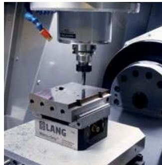
Mit den Linearantrieben erreicht man nicht nur schnellere Verfahrbewegungen, sondern in Eckbereichen ist auch eine präzisere Abbildung möglich. So werden Toleranzen von 1/100 mm sicher und auf Dauer erreicht.
