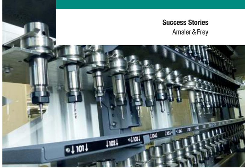
Die Rüstzeiten konnten durch den Werkzeugwechsler mit 200 Plätzen enorm reduziert werden.
