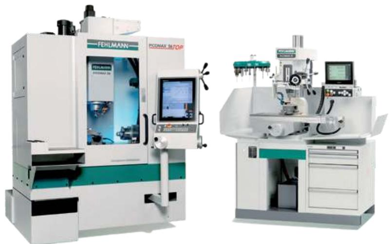
FEHLMANN-Baureihen PICOMAX-Fräsmaschinen/Bohrmaschinen zur einfachen, effizienten Produktion von Einzelteilen und Kleinstserien.
