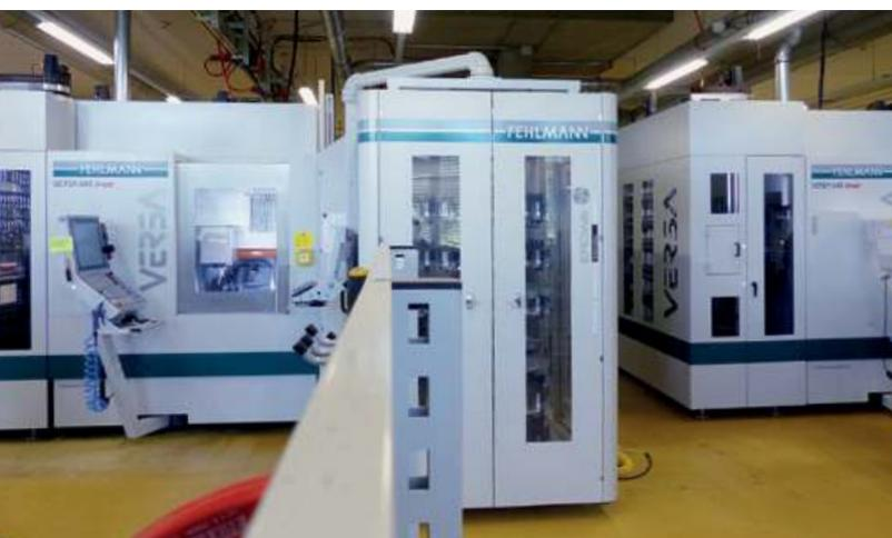
2018 investierte man in das erste 5-Achs-Bearbeitungszentrum VERSA 645 linear, 2019 folgte das zweite. Beide Anlagen sind mit einem Robot Multi (ERM) von Erowa verbunden.
